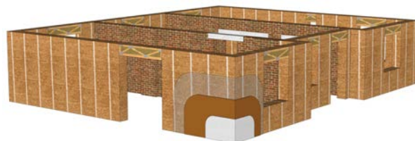
Рис. 9. Система зовнішніх стін із солом'яних панелей
