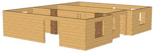
Рис. 7. Система зовнішніх стін із дерева
