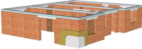
Рис. 6. Система зовнішніх стін з керамоблоків
